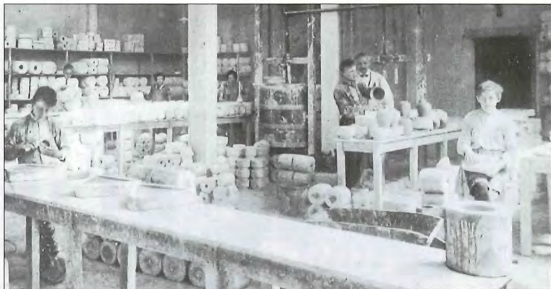
Afb.3. Interieur van de gieterij waar de modellen gegoten worden en hun eerste bewerking ondergaan. Rechts op de voorgrond zo'n gipsen gietmal. Meestal werden er twintig op een rij, van hetzelfde model, gevuld.
