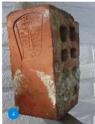
Radiaalsteen met bedrijfsstempel van Canoy-Herfkens.
